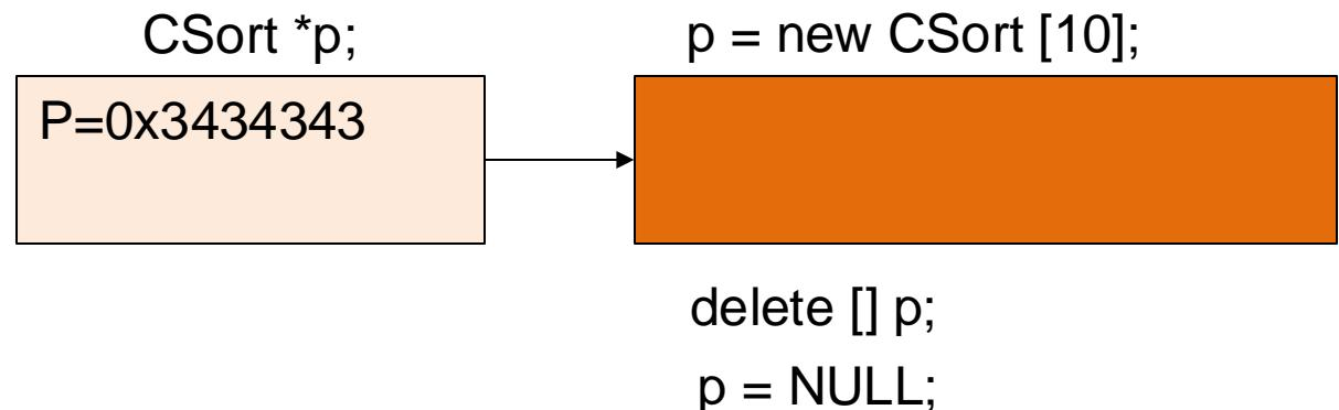
此时`a2=a1`这一句，`a2`原来的指针`p`丢失，内存泄漏。最后`a1`、`a2`析构的时候，原来`a1.p`被`delete[]`操作符删两次，可能出错。
